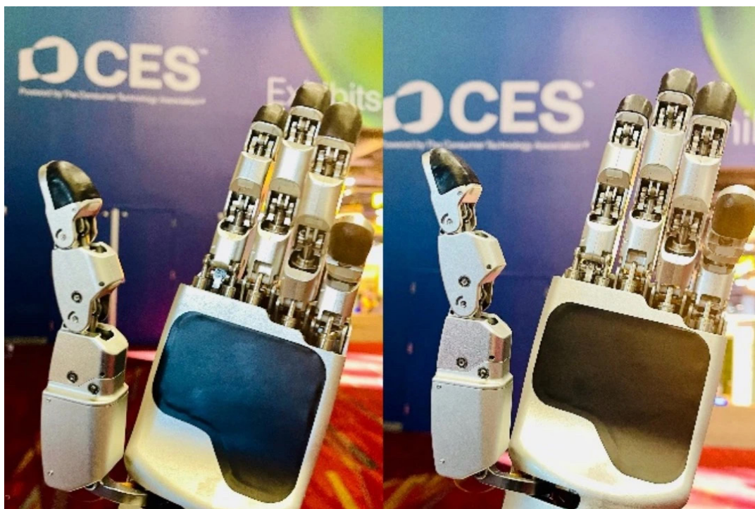
图1 搭载电子皮肤的五指灵巧手
